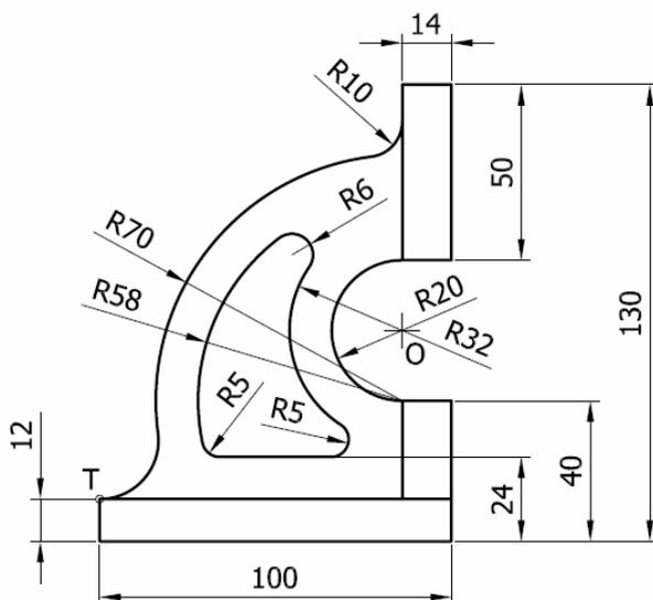
**Ejercicio 2:** Se da el croquis acotado de una forma técnica. Reproducir a escala 1/1 dejando reseñadas todas las construcciones auxiliares que se presenten. Los puntos de tangencia deben resaltarse mediante un pequeño trazo. Utilícese el centro "O" para centrar la forma en el formato.
